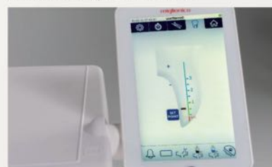
LOCALISATEUR D'APEX MANUEL Le localisateur d'apex peut également être utilisé en mode manuel, en connectant la sonde externe au panneau du praticien. En appuyant sur la touche dédiée dans le menu supérieur, l'écran affiche une barre colorée qui s'illumine progressivement et émet des signaux sonores pour indiquer l'approche de l'apex.
