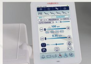
DÉTARTEUR Cet écran dédié permet de: • faire des traitements en modalité: Endo, Détartrage, Paro; • régler le débit de la pompe péristaltique; • activer la modalité proportionnelle.
