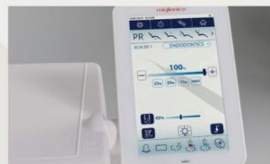
DÉTARTEUR Cet écran dédié permet de: • faire des traitements en modalité: Endo, Détartrage, Paro; • régler le débit de la pompe péristaltique; • activer la modalité proportionnelle.
